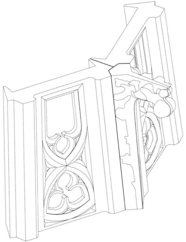
**Abb. 6** Münster. Georgsturm, Turmhelm. Rekonstruktionszeichnung: Ursprüngliche Zusammensetzung der Werkstücke am Beispiel der aneinander gefügten Masswerke und des eingeneteten Gratstücks mit Krabbe auf der Höhe des 5. Helmsegments. – Zeichnung: Philipp Ryffel.
