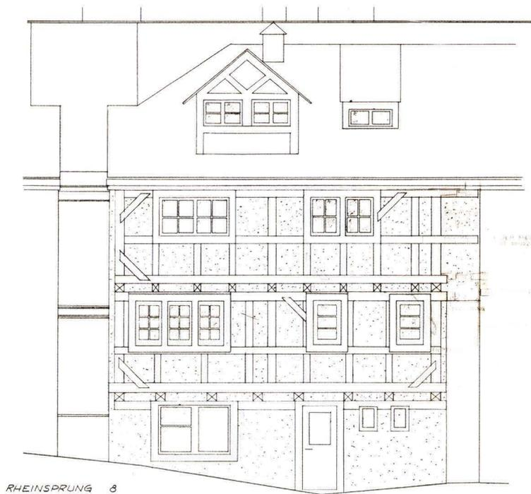
**Abb. 6** Rheinsprung 8. Aufnahmeplan des Fachwerks von 1967 (mit Bemerkungen zu Befunden und geplanten Veränderungen). – Zeichnung: ohne Angaben; Basis: TAD-Plan von Edgar Schneider, Architekt, 1943.
