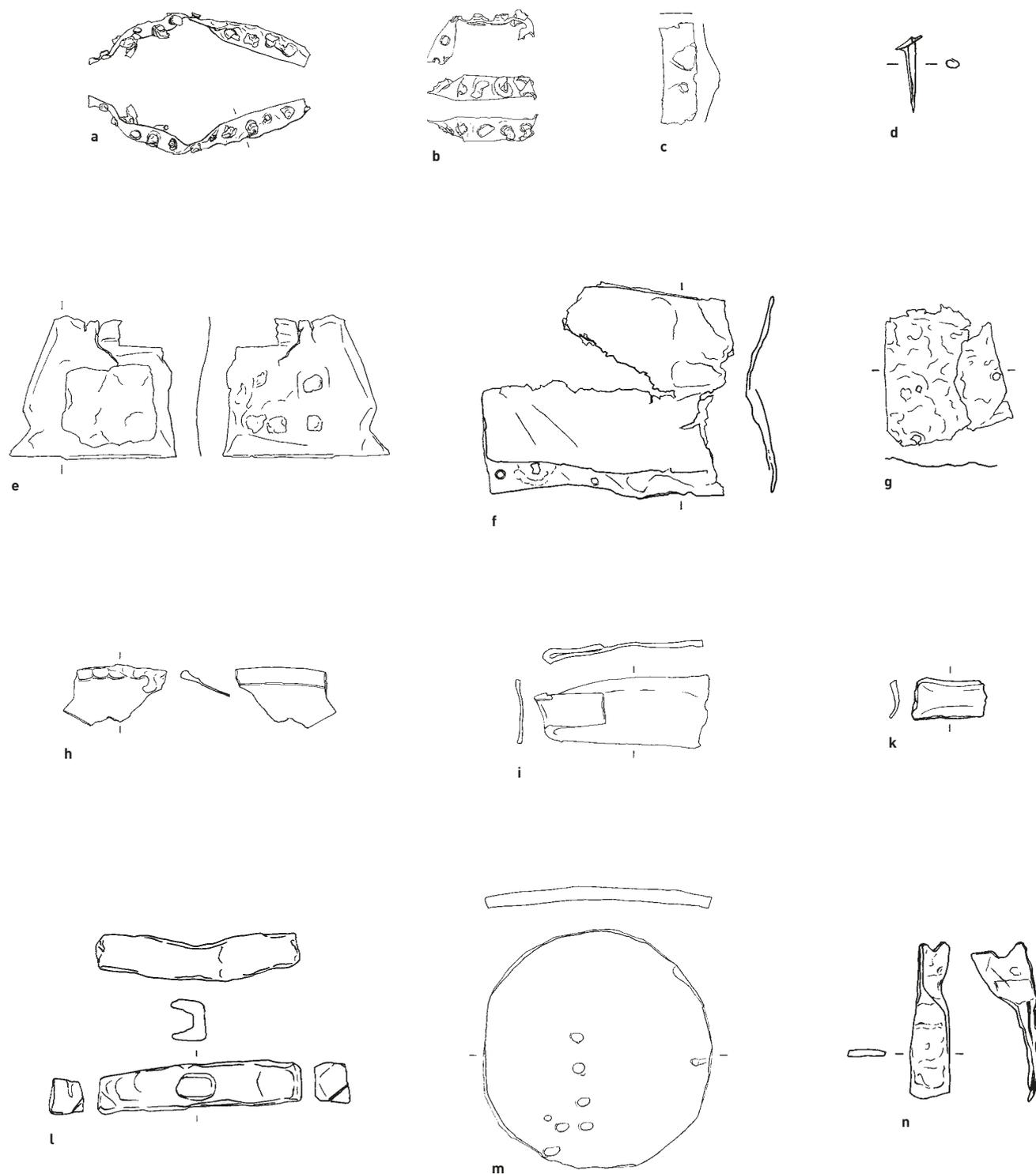
**Abb. 63** Martinsgasse 6+8 (2004/1). Bronzener Werkabfall eines Bronzeschmiedes (Kesselschmied? Kesselflicker?) und zugehörige Werkzeuge.
